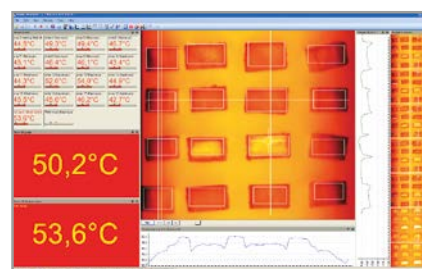
Caméra linéaire permet la mesure de température exacte pour les surfaces en verre en mouvement
