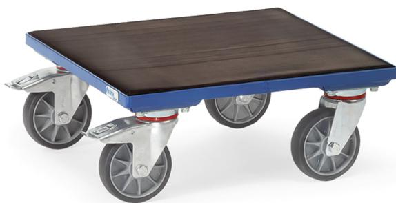
Plateau roulant en profilé d'acier avec plateau bois recouvert de TPE antidérapant, revêtement époxy bleu RAL 5007, 4 roues pivotantes à bandage TPE 125 x 32, moyeu à roulement à billes central. 2 roues avec freins
