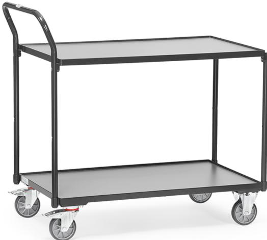
Ensemble mécano-soudé, revêtement époxy gris anthracite RAL 7016 avec 2 plateaux en mélaminé surface gris moyen, barre de poussée verticale, rebord de 12 mm. Charge maximum étagère haute: 80 kg. 2 roues pivotantes et 2 roues fixes à bandage TPE, moyeu à roulement à billes central. Freins sur roues pivotantes.
