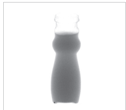
Contrôle du niveau de remplissage
